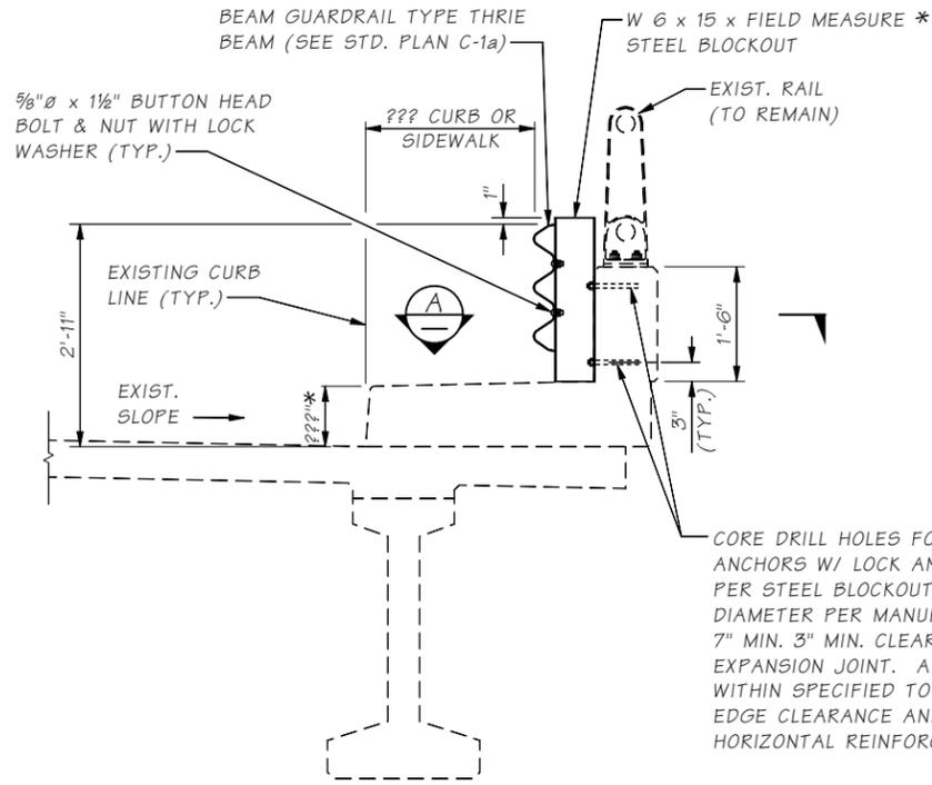
**TYPICAL SECTION AT STEEL BLOCKOUT**
